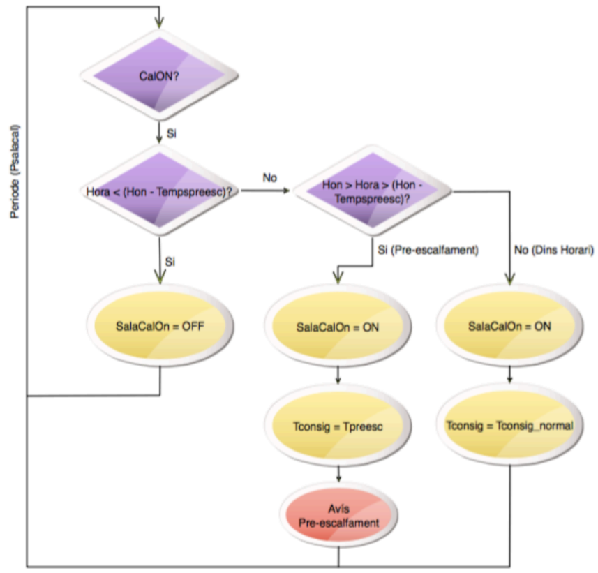
Figura 3: Algoritme de control de pre-escalfament
