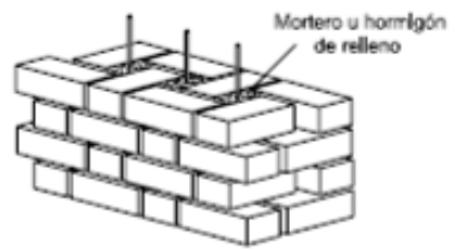
d) Muro armado en huecos aparejados
