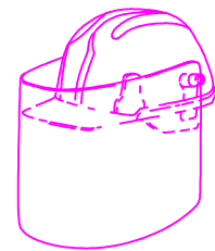
CASC DE SEGURETAT amb pantalla antiprojeccions Visor abatible
