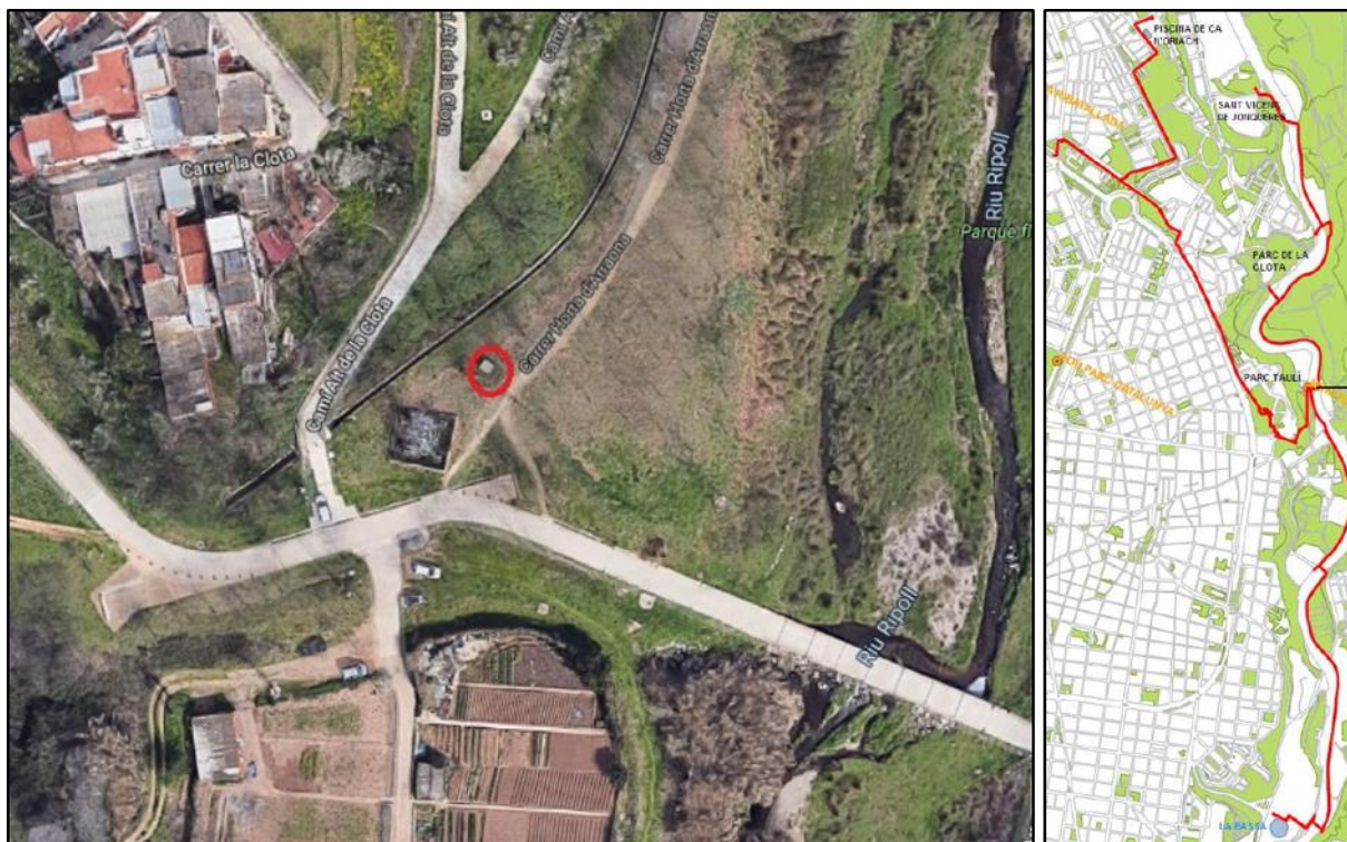
Figura 2_#3. Alternativa provisional #3: aprofitament de la mina del Ripoll, captació que travessa el llit del riu fins a un pou de bombament que permetia elevar l'aigua al dipòsit de la Torre de l'Aigua. L'ortofotomapa amb el cercle vermell a tocar del "Molí de Torrella" (just aigua amunt del "Pont de la Salut", és a dir, abans que la Sèquia Monar arribi a la CRHV) ha estat facilitat per la Sra. Núria Saperas, de l'Ajuntament de Sabadell. A la dreta, s'hi aprecia l'esquema de distribució de l'aigua procedent del conjunt mina + pou del Ripoll al llarg del riu, que arriba també fins a la zona de la CRHF. En tot cas, caldrà que l'Ajuntament aclareixi el funcionament exacte d'aquest aprofitament en cas de destinar-lo al reg de les CR.
