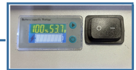
Display de LCD, de nivel de carga de batería, temperatura ambiente y voltaje
