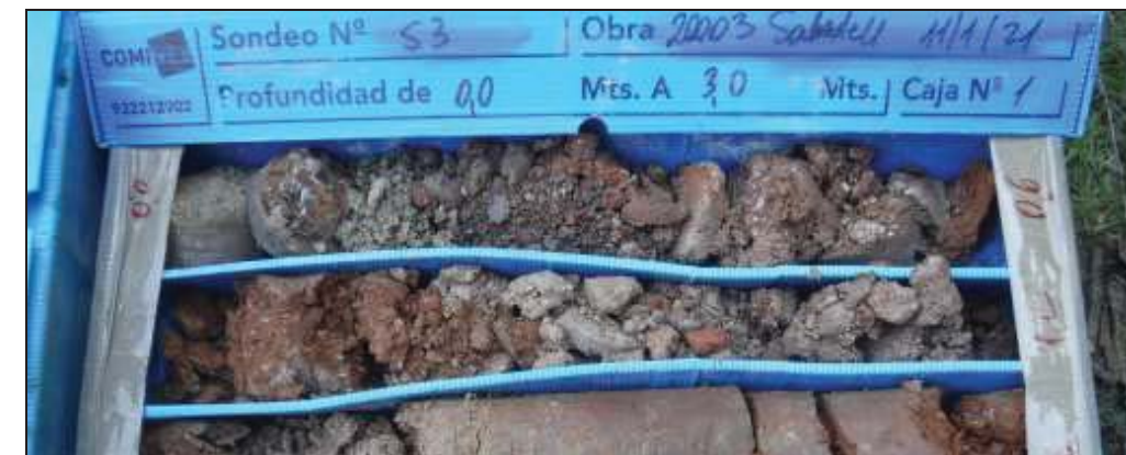
Materials de la capa R recuperats en una caixa de testimoni.
