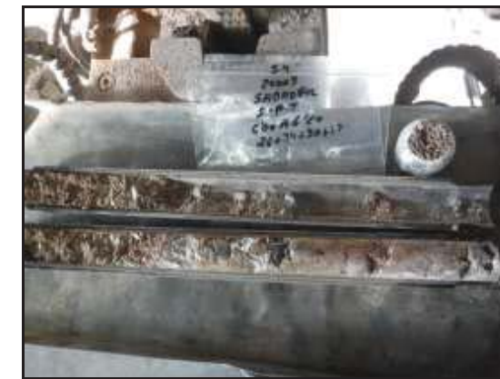
Foto 31: Sondeig S-4, SPT a 6,0 metres.
