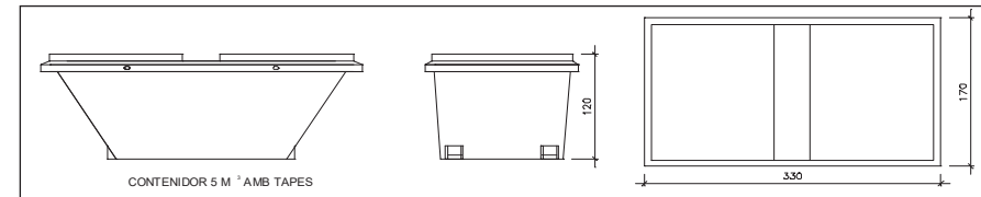
Contenedor 5 m³. Apte per a plàstics, paper i cartró, metalls i fusta unitats
