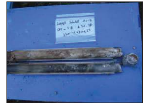
Foto 20: Sondeig S-3, SPT a 3,0 metres.
