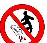
PROHIBIT TREPITJAR TERRA NO SEGUR
