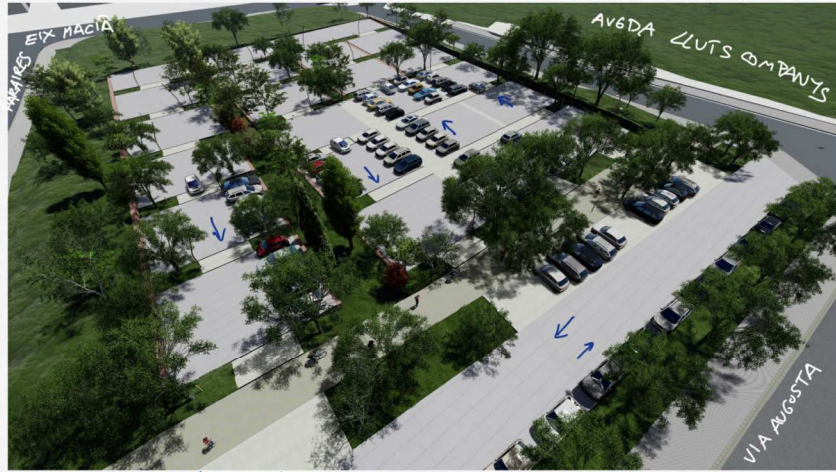
UN APARCAMENT EN PAQUETS DE 10 VEHICLES PER A MINIMITZAR LA SUPERFÍCIE PAVIMENTADA POSSIBILITANT L'OMBRATGE NATURAL (COBERTA ARBRADA), I MINIMITZAR L'IMPACTE VISUAL
